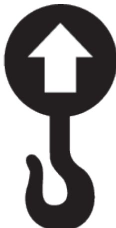
Symbole de point de levage/point d'ancrage
