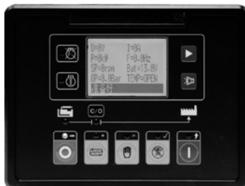
Figura 5.10 - Funcionamento Básico da Tecla Stop (Parar)
